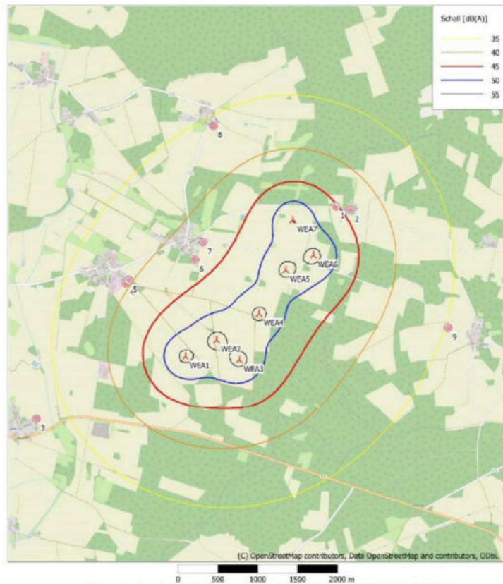
Abb. 2: Berechnung der Schallimmission der geplanten WEA bei 95 % Nennleistung; (anemos GmbH, 2020)
